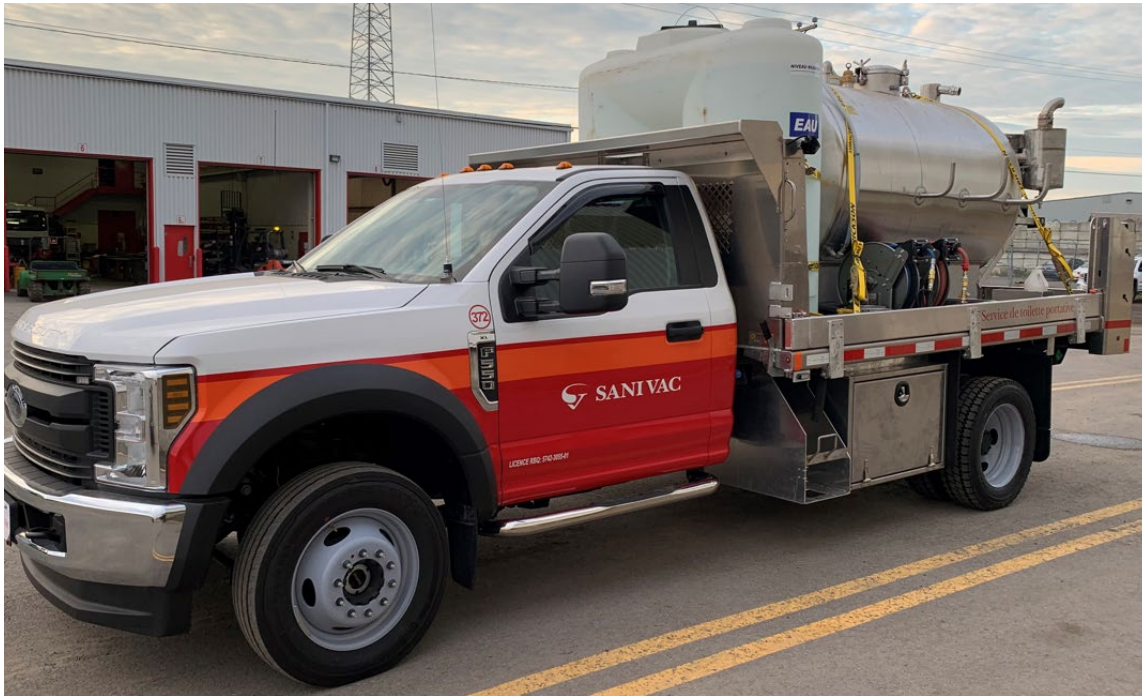
Exemple de camion classe 5, utilisé pour l'entretien de toilettes chimiques
